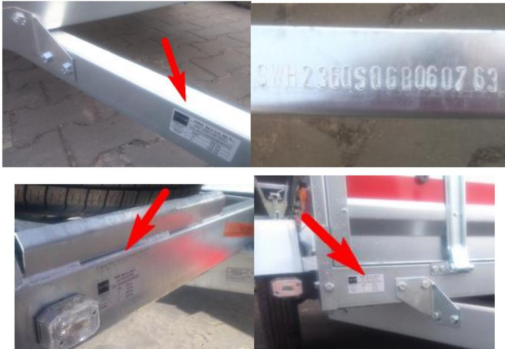
Abb. 1. Position des Typenschildes AM Anhänger
