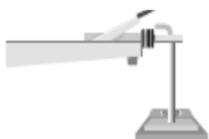
Die Personenwaage direkt unter den Kugelkopf stellen. Ein Rundholz auf eine passende Länge zuschneiden, um den Anhänger waagrecht zu stellen. Durch eine kleine Holzplatte verteilt sich der Druck gleichmäßig auf der Waage.
